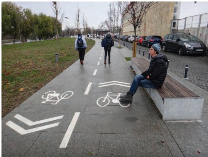
Fig. 9. Malul drept al Someșului. Pistă în dreptul Complexului de natație, cu bancă amplasată fără niciun spațiu de siguranță față de pistă. În partea opusă, există carosabil la câteva zeci de centimetri de marginea ei, deci nu e legal accesibilă pentru pietoni, aleea pietonală aflându-se la circa 10 metri în partea opusă, spre Someș. Se observă și eronata utilizare a marcajului sharrows
