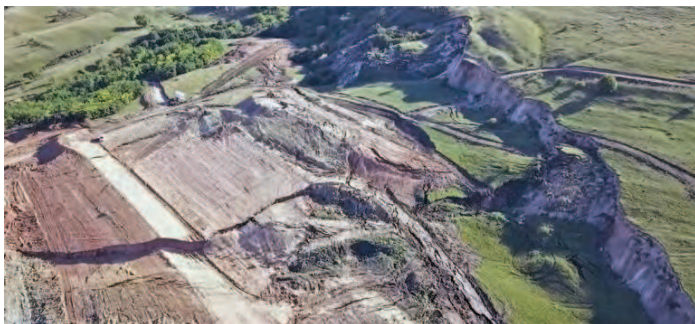
Fig. 43. Alunecări de teren recente în zona Clujului în urma extinderii infrastructurilor și a construcțiilor peste areale expuse la riscuri geomorfologice (Pro Infrastructura, 2021)
